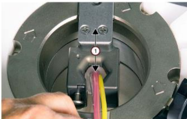
Hình 5-5: Cổ ly tâm phía dưới đã được định vị đúng
