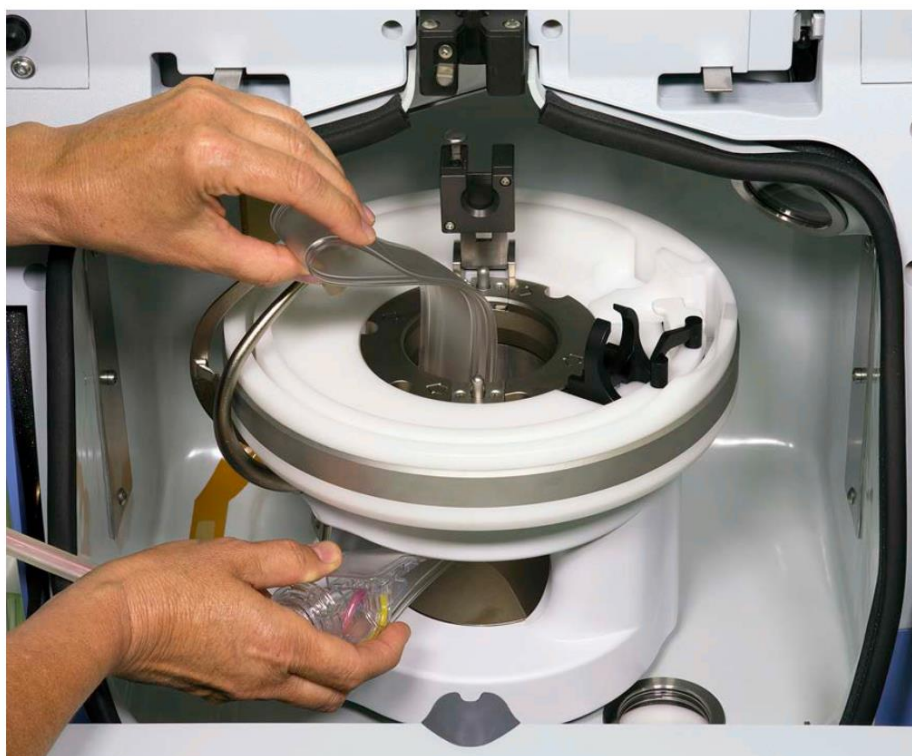
Hình 5-4: Bộ channel được kéo qua cổng nạp (hình này mô tả cho Bộ thu nhận)
