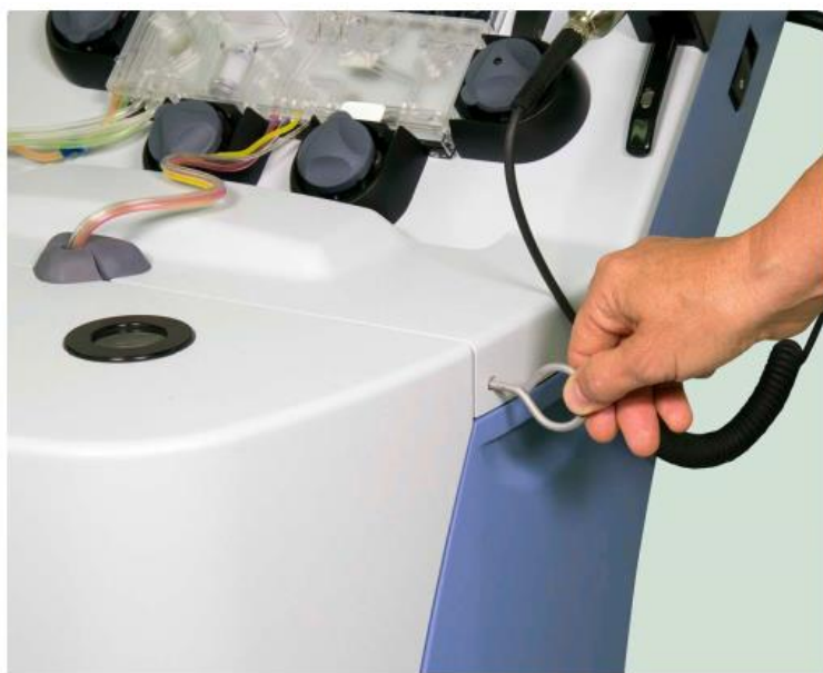
Hình 16-7: Chìa khóa cửa buồng ly tâm trong lỗ nhả khóa
