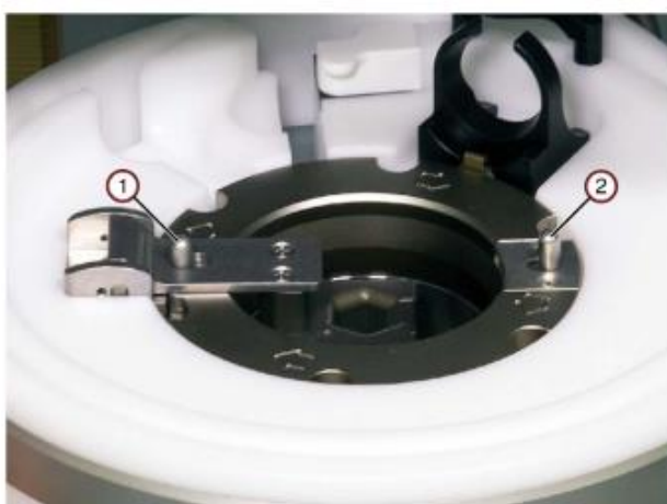
Hình 5-1: Vị trí của đinh chốt filler (1) và chốt khóa filler (2)
