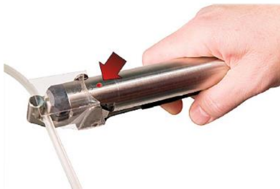
Hình 15-2: Giữ mỏ kẹp đóng đến khi đèn chỉ thị sáng
