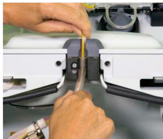
Hình 5-12: Cổ ly tâm trên được cố định vào kẹp giữ cổ ly tâm trên
