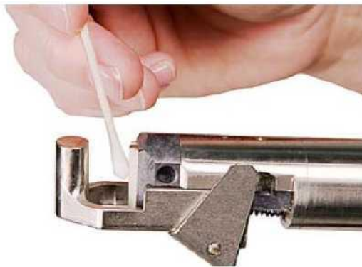
Hình 17-2: Vệ sinh rãnh mỏ kẹp bằng tăm bông
