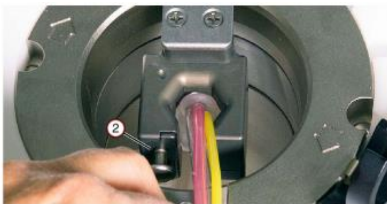
Hình 5-6: Cổ ly tâm phía dưới đã được định vị đúng và được khóa lại, có thể nhìn thấy rãnh của chốt khóa
