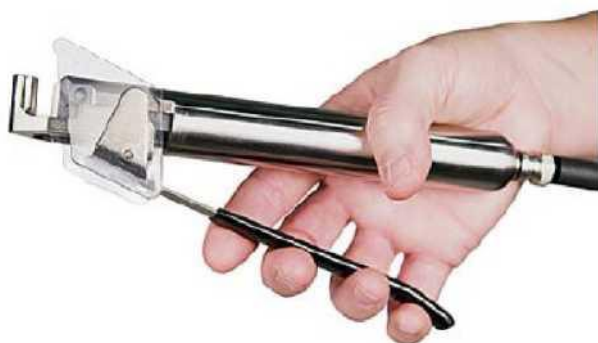
Hình 15-1: Giữ đầu hàn với mỏ kẹp hướng lên trên
