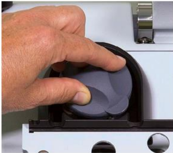
Hình 17-1: Tháo rotor khỏi vỏ bơm
