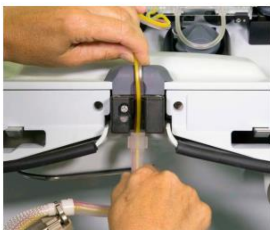
Hình 5-11: Đường ống được gắn vào kẹp giữ cổ ly tâm trên
