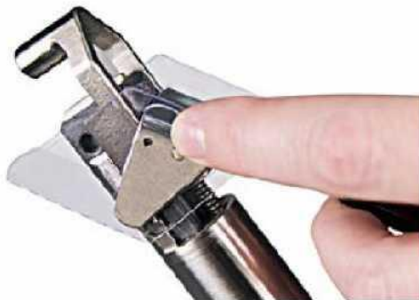
Hình 17-10: Gắn tấm chắn vào và khóa nó vào vị trí
