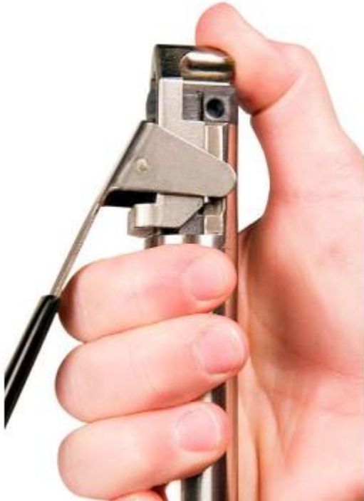
Hình 17-3: Ấn mỏ kẹp xuống vị trí đóng
