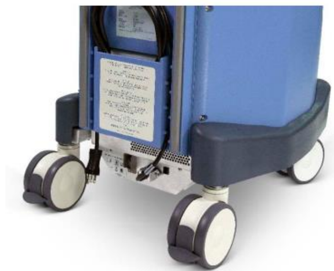
Hình 3-3: Các cần thắng bánh xe sau ở vị trí khóa
