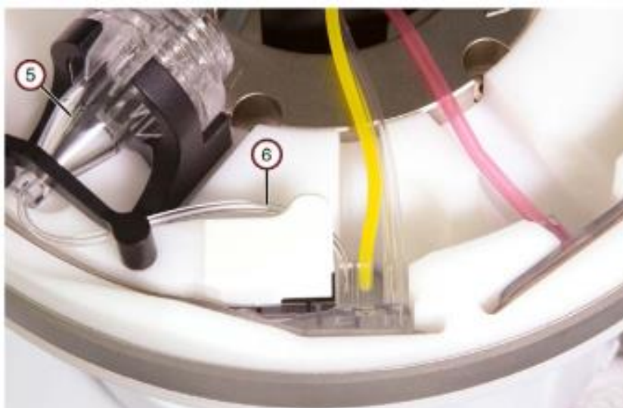
Hình 5-8: Đường thu nhận máu được đặt đúng vị trí sau mép tham chiếu quang học
