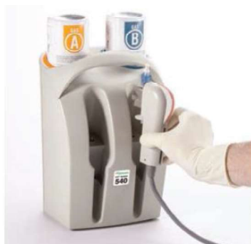
Đầu cath có gắn bộ cảm biến được đặt trên bộ hiệu chỉnh
