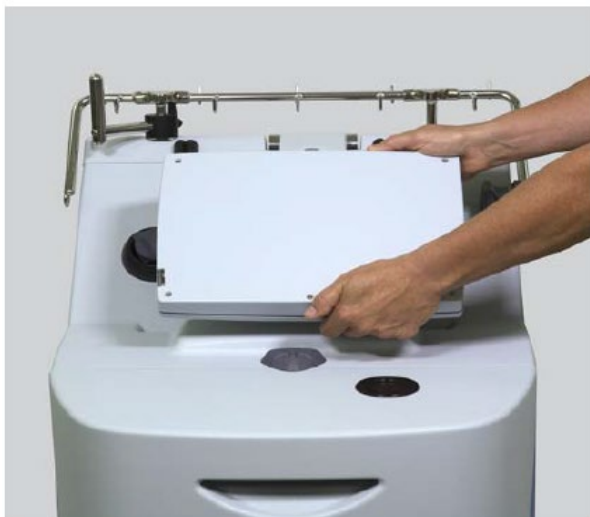
Hình 3-1: Màn hình sau khi được hạ xuống trước bảng điều khiển phía trước.
