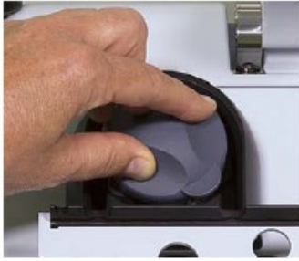
Hình 17-1: Tháo rotor khỏi vỏ bơm
