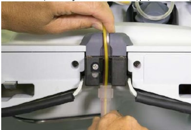
Hình 5-10: Đường ống được gắn vào kẹp giữ cổ ly tâm trên
