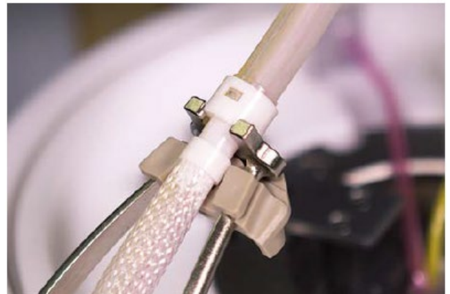
Hình 5-9: Ống trực trên được gắn vào kẹp giữ ống trực trên
