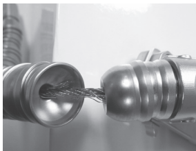
Afbeelding 3 – Voorbeeld van een rafelende kabel – NIET GEBRUIKEN
