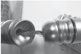
Şekil 7 – Yorulma ve yıpranma görülen kablo
