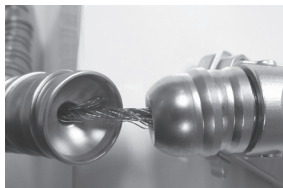
图 7 - 出现疲劳和磨损的线缆
