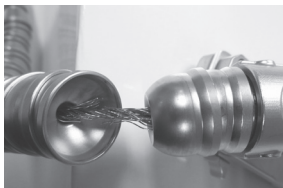
Rysunek 7 – Zużyta i postrzępiona linka
