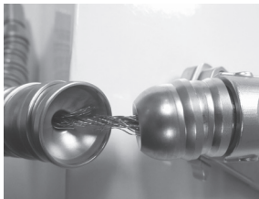
3. ábra – Kirojtosodott kábel megjelenése – NE HASZNÁLJA!
