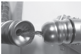
Abbildung 7 – Verschlissenes und ausgefranztes Kabel
