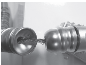
Рисунок 3 — Внешний вид расщепленного тросика — НЕ ИСПОЛЬЗОВАТЬ!
