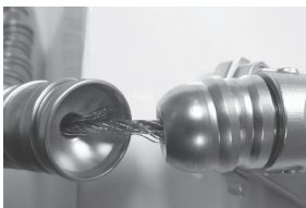
Figur 7 – Kabel med materialtretthet og slitasje
