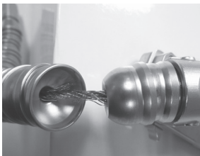
Figur 3 – Sådan ser et flosset kabel ud – MÅ IKKE ANVENDES
