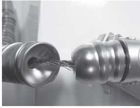
Şekil 3 – Yıpranmış bir kablonun görünümü – KULLANMAYIN
