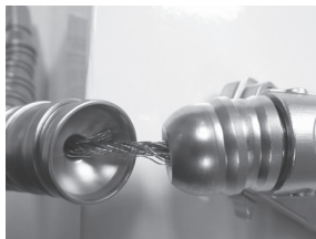
图 3 - 磨损线缆外观 - 请勿使用
