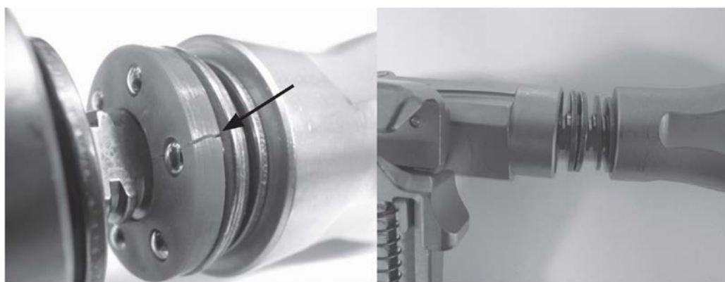
Hình 8 – Gioăng nylon bị nứt
