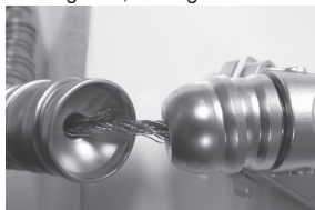
Figure 7 – Exemple d'usure et d'effilochage d'un câble
