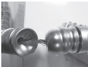
Figure 3 – Aspect d'un câble effiloché – NE PAS UTILISER
