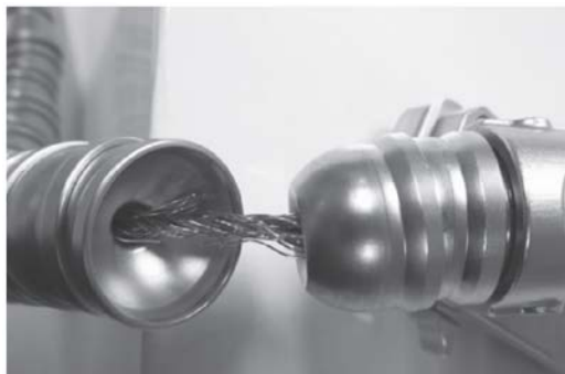
Hình 7 – Cáp bị bện mối và trầy xước
