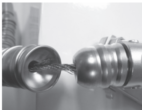
Abbildung 3 – Ausgefranztes Kabel – NICHT VERWENDEN
