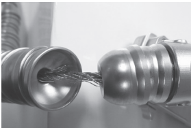
Figur 7 – Kabel som uppvisar utmattning och nötning
