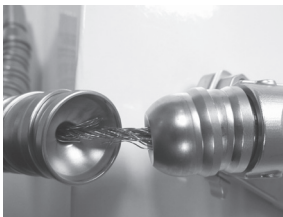
Figur 3 – Utseendet til en slitt kabel – MÅ IKKE BRUKES
