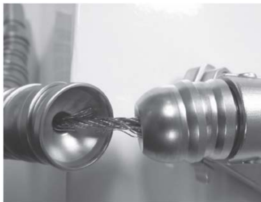
Hình 3 – Cáp bị hư hỏng – KHÔNG SỬ DỤNG
