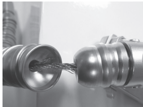
Kuva 3 – Rispaantuneen kaapelin ulkonäkö – ÄLÄ KÄYTÄ
