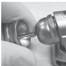
Figur 2 – Utseendet på en normal kabel
