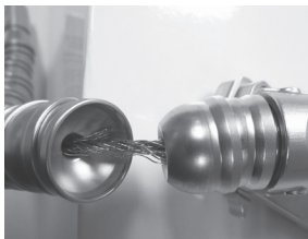
Rysunek 3 – Wygląd postrzępionej linki – NIE UŻYWAĆ
