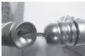
Figura 7 – Cabo demonstrando fadiga e desgaste
