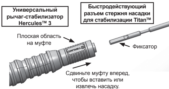
Рисунок 3 – Присоединение насадки для стабилизации Titan™ к универсальному рычагу-стабилизатору Hercules™ 3
