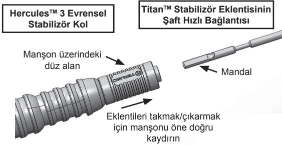
Şekil 3 – Titan™ Stabilizör Eklentisinin Hercules™ 3 Evrensel Stabilizör Koluna takılması
