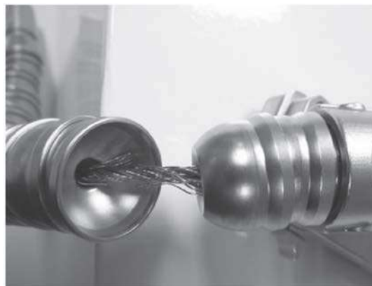
Hình 3 – Cáp bị hư hỏng – KHÔNG SỬ DỤNG
