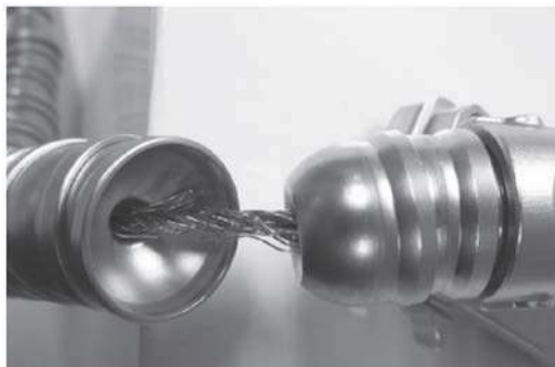
Hình 7 – Cáp bị bện mối và trầy xước
